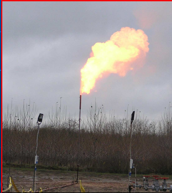
Post-acid: 6mm; 40k m 3 /d; WHP=85 bar
